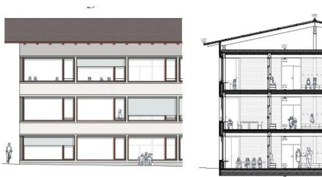
Abb. 20: Fassadenansicht und Detailschnitt Neubau
