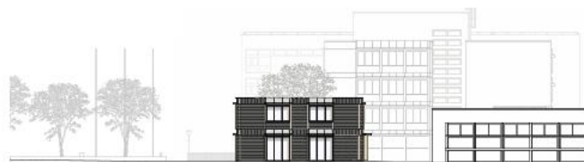
Neubau Tagesschule & Produktionsküche | Fassade Nord | Mst. 1:200
